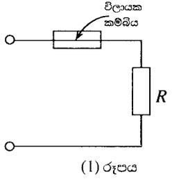
එක්තරා විලාසකයක ධාරාව  $5 \text{ A}$  ලෙස ප්‍රමාණනය කර ඇත. විලාසක කම්බියේ දිග  $3 \text{ cm}$  ද එහි අරය  $0.1 \text{ mm}$  ද (හරස්කඩ වර්ගඵලය  $\sim 3 \times 10^{-8} \text{ m}^2$ ), සහ  $25^\circ \text{C}$  දී කම්බිය සාදා ඇති ද්‍රව්‍යයේ ප්‍රතිරෝධකතාව  $1.7 \times 10^{-8} \Omega \text{ m}$  ද නම්, කාමර උෂ්ණත්වය වන  $25^\circ \text{C}$  හි දී විලාසක කම්බියේ ප්‍රතිරෝධය ගණනය කරන්න.
