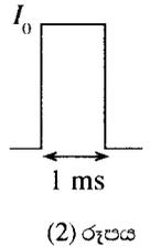
(iv) (3) රූපයේ පෙන්වා ඇති ආකාරයට  $230 \text{ V}$  වෝල්ටීයතාවක් යොදා ඇති භාරයක් සහිත පරිපථය  $XY$  හි දී ලුහුවත් වී ඇති අවස්ථාවක් සලකන්න. මෙම අවස්ථාවේ දී  $5 \text{ A}$  විලාසකයක් හරහා ධාරාව ගණනය කරන්න. (b) (iii) හි ලබා ගත් ප්‍රතිඵල භාවිතයෙන් මෙහි දී මිලිතත්පර  $1$  කට ප්‍රථම විලාසකය දැවී යන බව පෙන්වන්න. (මෙහි ලැබෙන ධාරාව සෘජුකෝණාස්‍රාකාර ධාරා ස්පන්දයක් ලෙස උපකල්පනය කරන්න.)
