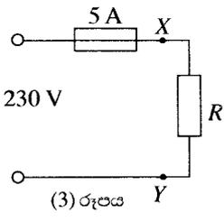
(v)  $1 \mu\text{s}$  කාලයක් තුළ ඇති වන  $500 \text{ A}$  සෘජුකෝණාස්‍රාකාර පටු ධාරා ස්පන්දයක්  $5 \text{ A}$  විලාසකයක් හරහා ගමන් කරයි. මෙම අවස්ථාවේ දී විලාසකය දැවී යයි ද? සුදුසු ගණනය කිරීමක් භාවිතයෙන් ඔබේ පිළිතුර සත්‍යාපනය කරන්න.
