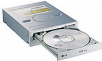
படம் :- 3.1.6 இறுவட்டு இயக்கி (Compact Disk Drives) (உள்ளீட்டு மற்றும் வெளியீட்டுக் கருவியாக பயன்படுத்தலாம்) (உள்ளீட்டுக் கருவி)
