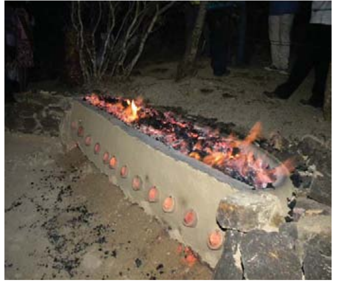
உரு 1.22 இரும்பை உருக்குவதற்குப் பயன்படுத்தப்பட்ட சூளை
