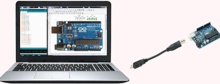
පරිගණකය හා Arduino පුවරුව සම්බන්ධ කරන රහැන සැලකු විට එහි එක් කෙළවරක් USB ද අනෙක් කෙළවර Mini USB ලෙස ද පවතී. මෙහි USB කෙළවර පරිගණකයට ද, Mini USB කෙළවර Arduino පුවරුවට ද සම්බන්ධ කෙරේ.
