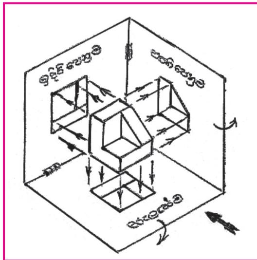
ඉන් පසු ඉදිරි පෙනුම අඳින ලද තලය එසේ ම තිබිය දී සැලැස්ම අඳින ලද තලය පහළටත්, පැති පෙනුම අඳින ලද තලය දකුණු පසටත් දිග හැර තල තුන සමතලයක් මත තැබීමෙන් ඉදිරි පෙනුමත් එයට පහළින් සැලැස්මත් ඉදිරි පෙනුමට දකුණු පසින් පැති පෙනුමත් රූප එකිනෙක ප්‍රක්ෂේප වන අයුරින් පෙනේ.
