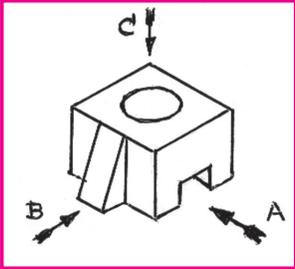
එහෙත් එයට පහළින් දැක්වෙන සෘජු ප්‍රක්ෂේපණ (Orthographic projection) රූප තුනෙන්, A දෙසින් බැලූ විට පෙනෙන ඉදිරි පෙනුම (Front elevation) B දෙසින් පෙනෙන පැති පෙනුම (Side elevation) ඉහළින් පෙනෙන සැලැස්ම (Plan) වෙන වෙන ම ප්‍රදර්ශනය වන අතර, අදාළ සියලු ම මිනුම් ද පැහැදිලි ව දැක්විය හැකි ය.
