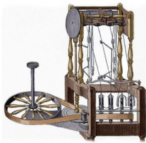
රූපය 1.2 - විවිධ ආරක්ෂක විසින් නිපදවන ලද පල බලයෙන් ක්‍රියා කරන නූල් කට්ටන යන්ත්‍රය
